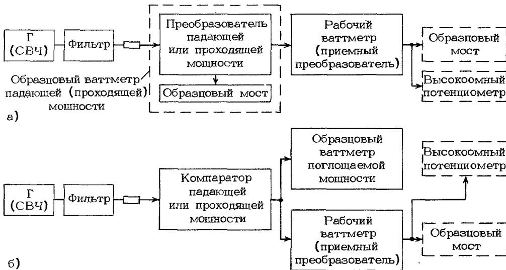
Рис. 3.70. Структурная схема определения основной погрешности терморезисторных ваттметров: а — с образцовым ваттметром; б — с образцовым компаратором
