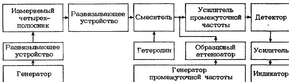
Рис. 10.3. Схема измерения ослабления методом последовательного замещения на промежуточной частоте
