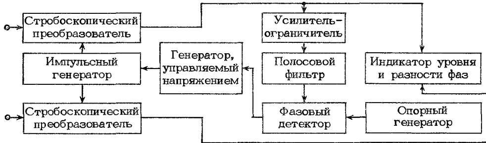
Рис. 8.31. Измеритель фазы со стробоскопическим преобразователем частоты
