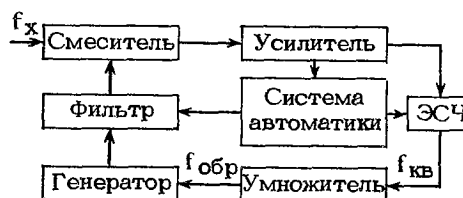
Рис. 7.13. Структурная схема измерения частоты при помощи ЭСЧ и дискретного преобразователя с автоматически перестраиваемым фильтром
