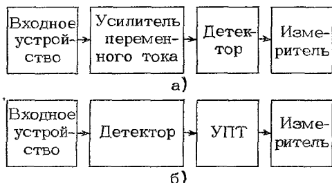
Рис. 2.53. Структурные схемы электронных аналоговых вольтметров
