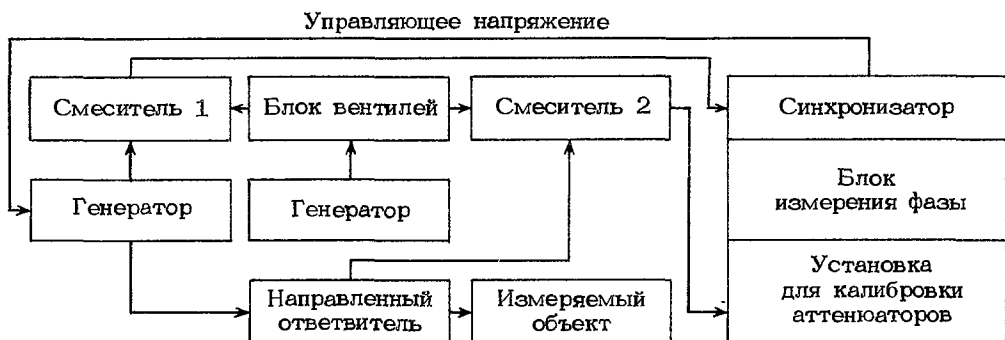
Рис. 10.12. Схема измерения больших КСВ с помощью направленных ответвителей и установки ДК1-12
